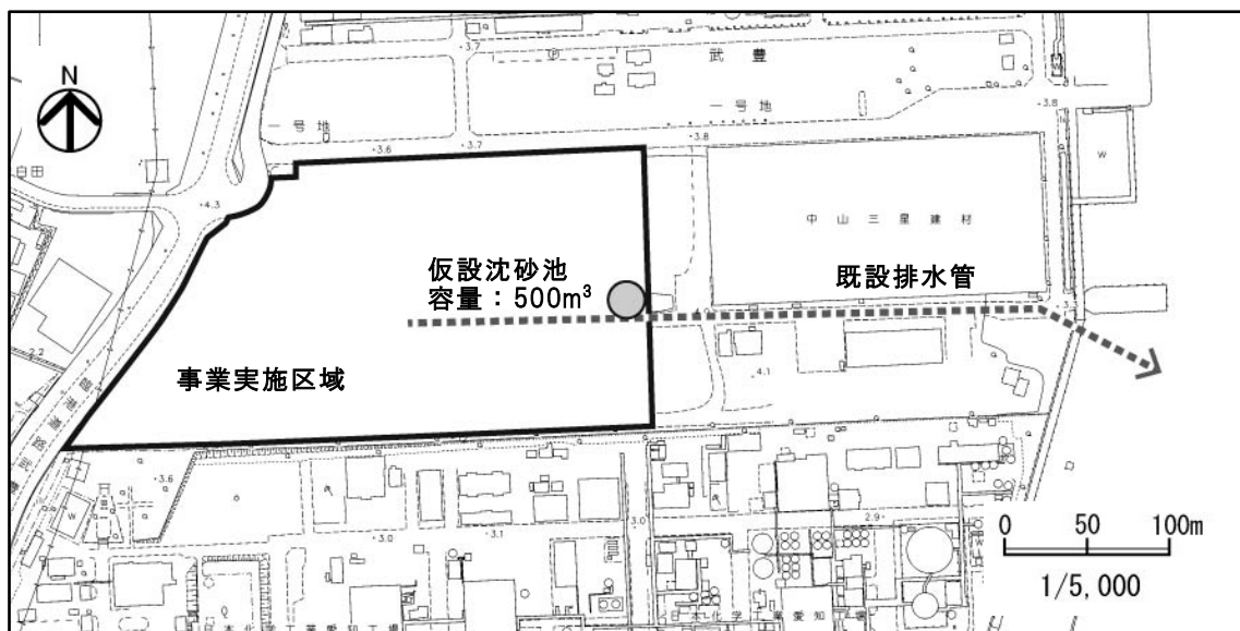
図 2.2-14 工事中の排水経路図
