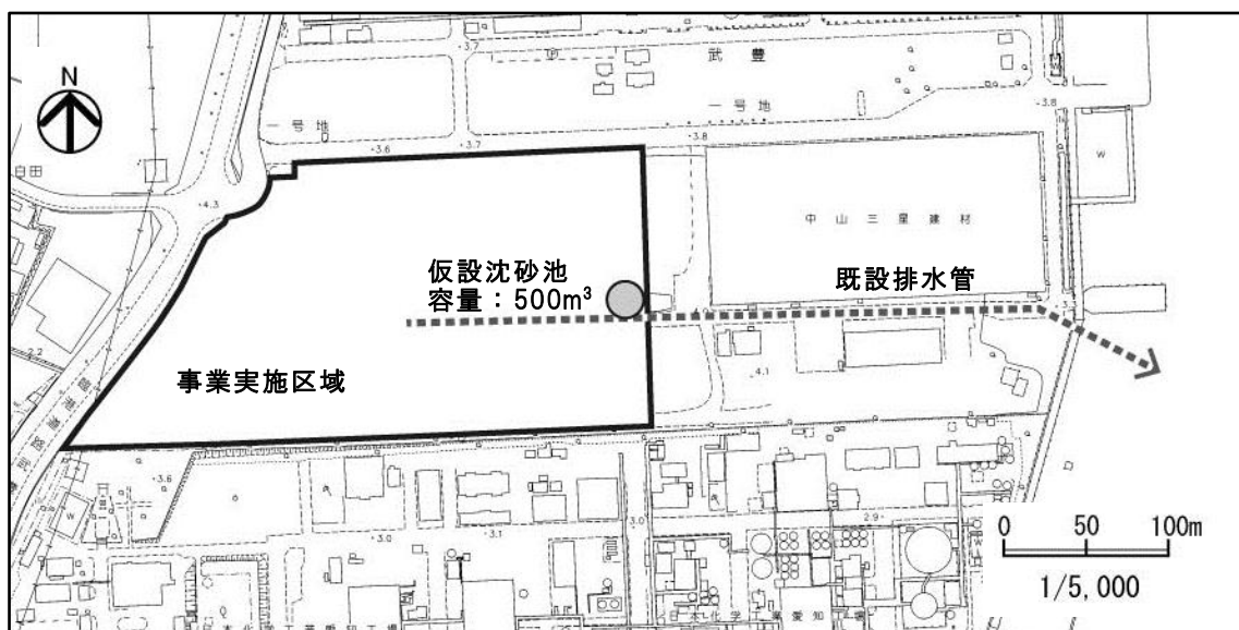
図 2.2-14 工事中の排水経路図
