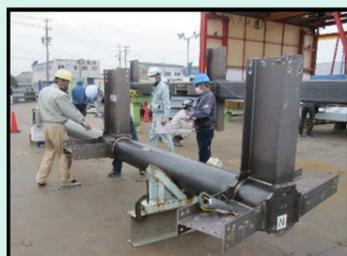
組合の事務所や、環境教育を行うための部屋がある「管理棟」の工事が昨年12月から開始しています。この日は管理棟の主要な柱や梁を製作している工場に赴き、柱となる鉄骨が設計通り作られているか、溶接部に欠陥が生じていないかを確認しました。
