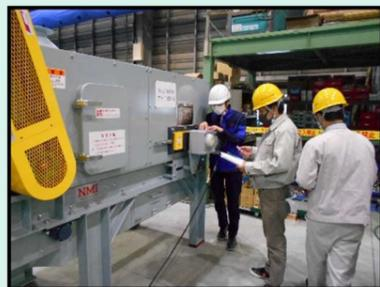
不燃・粗大ごみが破碎された後、その破碎物は可燃物・アルミ類・鉄類・不燃物に選別されます。このうちアルミを磁力で選り分けるのはたらしをするのがアルミ選別機です。この日は製作されたアルミ選別機が正常に動作を行うかどうか等を確認しました。
